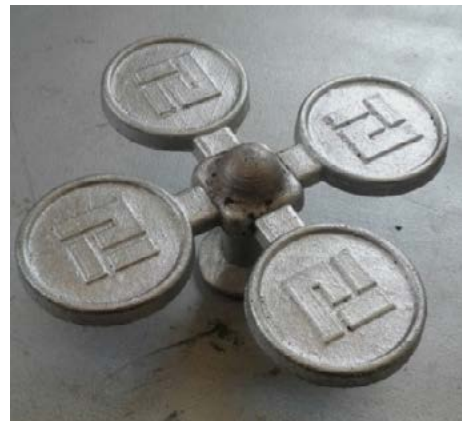
Figura 10: Árbol obtenido de modelos plásticos.
