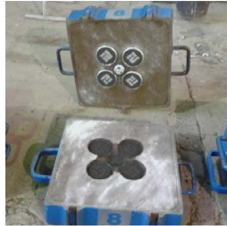
Figura 9: Pieza colada en molde.
