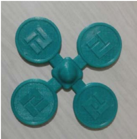
Figura 7: Modelo realizado con PETg.
